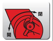
使用時は必ず空気弁を開いてか ら使用してください。
